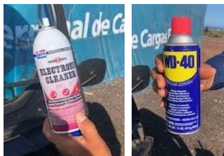
Figura 40- Líquido para limpiar conexiones eléctricas (izq) y aceite WD-40 para colocar en las piezas metálicas (derecha).
