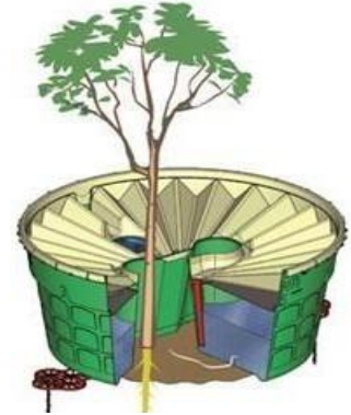
Figura 6-Diagrama de Waterboxx mostrando la mecha en posición cercana a las raíces de la planta.
