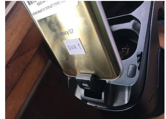
Figura 45-Colocación del teléfono en el puerto
