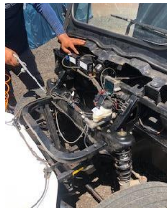
Figura 39- Limpieza de partes internas del vehículo con compresor
